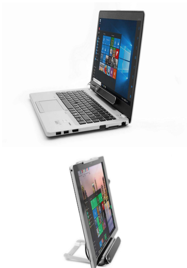
Фиг. 1. Устройството за контрол с поглед се закрепва под екрана на лаптоп или на таблет и се включва в USB вход.
